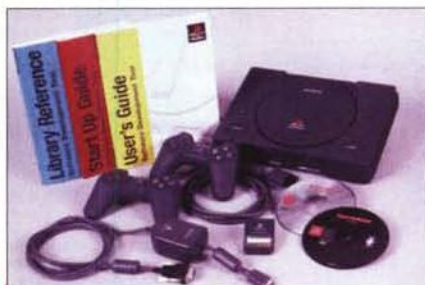
Figura 2 - Il kit Yaroze al completo. Console PlayStation dedicata, manuali, programmi applicativi su CD-ROM, joy-pad, cavo-TV e chiave elettronica. A tutto ciò andrà ora affiancato (e interconnesso via seriale) un normale PC multimediale ed un TV-color.
